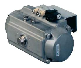
Pour optimiser le pilotage de l'actionneur, il est recommandé d'utiliser l'électro-distributeur dans sa version 5/2 1EV « effet monostable ». La position au repos est la position « Volet fermé », c'est à dire qu'en cas de coupure d'alimentation électrique le système se mettra en position « volet fermé ».
